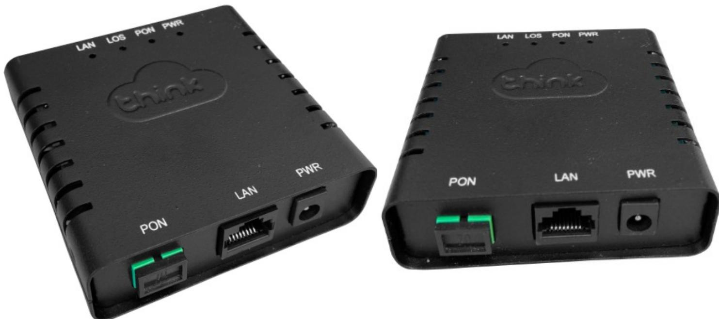
A ONU é destinada a redes FTTH funcionando nos dois padrões GPON (*Downlink* de 2.5Gbps e *Uplink* de 1.25Gbps) e GEAPON (*Downlink* de 1.25Gbps e *Uplink* de 1.25Gbps). A função *auto-detect* permite que o equipamento identifique automaticamente o padrão, a ser utilizado em sua rede.
