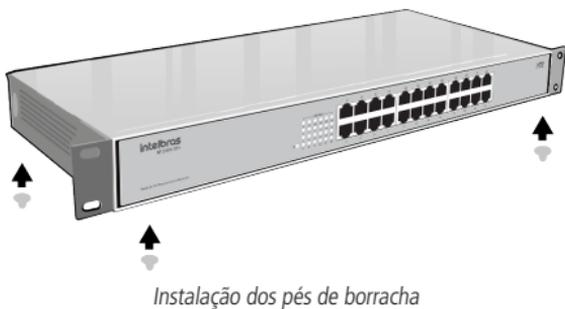
**Obs.:** o gabinete metálico do switch foi projetado para suportar até 5 kg de peso em sua parte superior.
