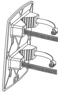
Para montagem em parede, fixe primeiro o suporte na parede e depois encaixe o APC 5A.
