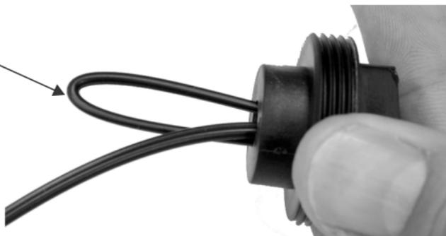
**8.2** Retire a película protetora da fita mastic e enrole-a em volta do cabo em espiral sem exercer muita pressão próximo à entrada do tubo, conforme imagem a seguir:
