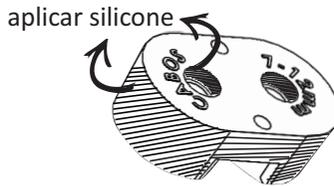
**9.3.5** Passe os cabos pelos orifícios da borracha de vedação e posicione a borracha na entrada oval, passando 3 cm do cabo para o interior da caixa, conforme imagens a seguir:
