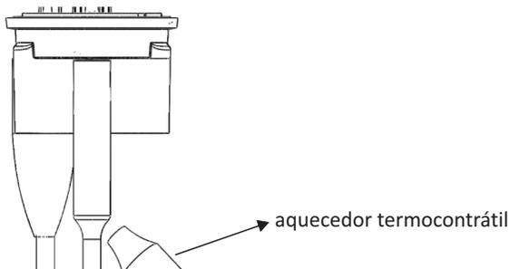
**12.6** Repita o passo 10 desse manual para realizar a emenda por fusão das fibras que serão derivadas.
