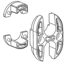
**9.3.3** Para a instalação em sangria, faça um corte (conforme indicado ao lado) na borracha de vedação para passagem dos tubos loose.
