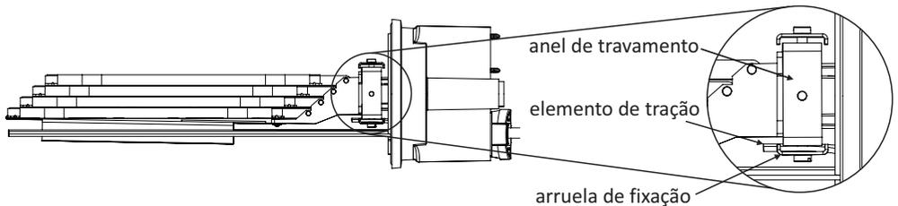
**9.3.7** Posicione a parte central da trava da reentrada entre os cabos e, em seguida, encaixe as extremidades envolvendo os cabos, conforme imagens a seguir. Com o auxílio de uma chave phillips, realize o aperto da trava utilizando os parafusos da mesma.
