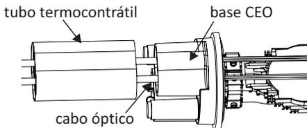
**Obs:** A borda sem adesivo do tubo termocontrátil deve ser orientada para o lado da base, enquanto que a borda que possui adesivo deve ficar orientada para o lado dos cabos.
