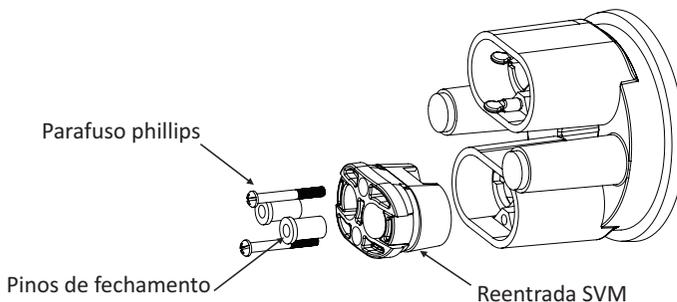
**9.3.2** Desmonte as travas plásticas da reentrada, conforme imagem ao lado e retire o grommet do alojamento interno oval. Retire os pinos de fechamento dos orifícios da borracha de vedação.
