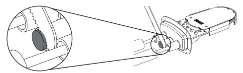
**8.3.2** Lixe a entrada aberta na parte externa para promover uma melhor aderência do tubo termocontrátil, conforme imagem a seguir:
