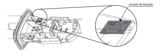
**8.2.2** Armazene uma volta de tubo loose e fixe-o com uma abraçadeira plástica na furação perto da arruela de fixação, conforme indicado a seguir:
