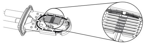
**8.2.5** Encaixe com cuidado a tampa de acrílico retirada no item **8.2.3**, posicionando a frente da tampa nas travas dianteira da bandeja, em seguida encaixe a tampa de acrílico nas garras de contenção, conforme esquema a seguir:
