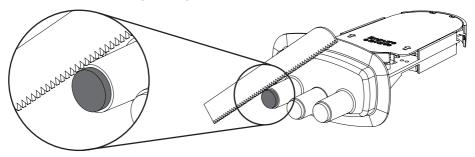
**8.1.3** Lixe as entradas abertas na parte externa para promover uma melhor aderência do tubo termocontrátil, conforme imagem a seguir:
