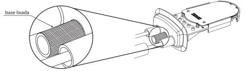
**8.3.3** O cabo deve ser lixado em aproximadamente 10cm a partir da decapagem. Insira um tubo termocontrátil no cabo, em seguida, passe-o pela entrada da base, na caixa.
