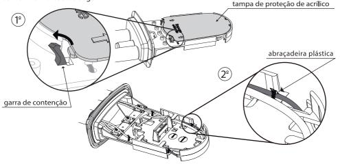
**8.2.4** As canaletas da bandeja podem alojar até 2 emendas cada uma (a bandeja comporta até 12 emendas). Acomode as fibras na bandeja, realize as fusões necessárias e acomode os protetores de emenda na borracha canaleta, conforme imagem a seguir:
