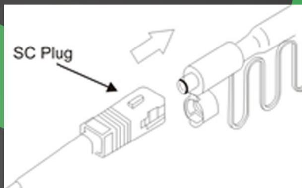
3 EMPURRE O ALOJAMENTO PARA COMEÇAR A LIMPAR A FACE FINAL DO CONECTOR SC. CLIQUE EM UM SOM PARA INDICAR O FIM DO PROCESSO DE LIMPEZA. FECHÉ A TAMPA APÓS O USO.
